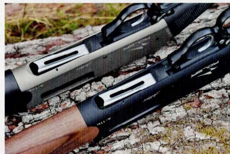
Nachgeladen wird wie bei anderen Flinten mit Röhrenmagazin, die Double-Load-Nachladetechnik stellt kein Problem dar.
