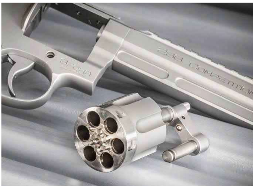
Soll die Trommel entnommen werden, ist die vordere Torxschraube der Schlossplatte zu lösen. Die unter Federdruck stehende Kugel im Trommelkran besorgt in einer korrespondierenden Ausfräsung im Rahmen die vordere Trommelverriegelung.
